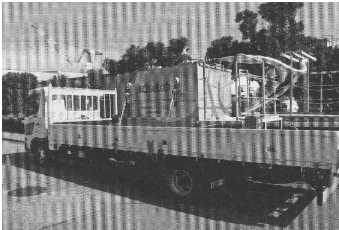
図 3-26 「サーモウェイ」蓄熱装置（4トン機） 17)
